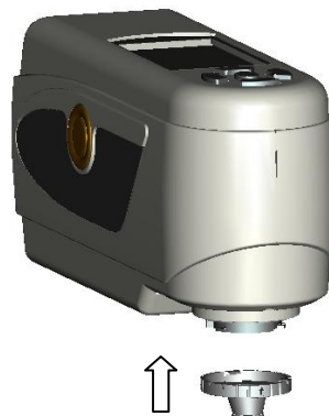
图 12 加长测量口径对准安装孔位
